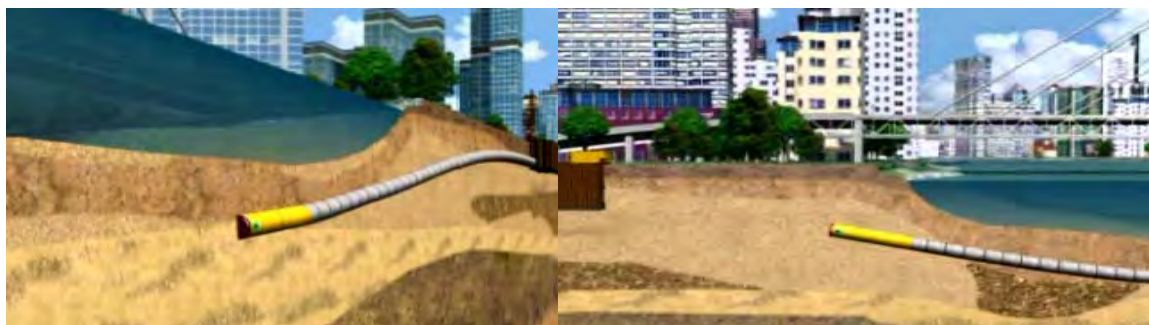
شکل ۵-۱۰-۲- نمایش مسیر لوله رانی از زیر رودخانه
