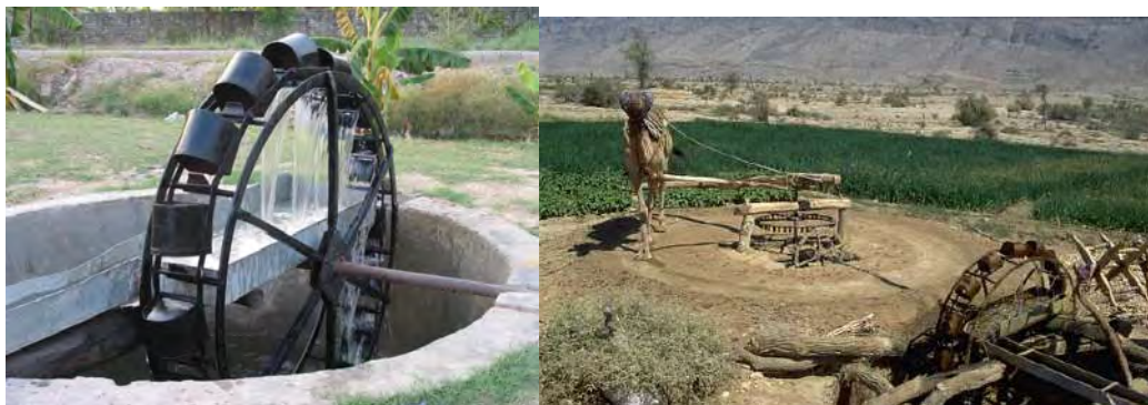
شکل ۶-۱۱-۲- دولاب یا چرخ ایرانی که با نام (Persian Wheel) در جهان شناخته می‌شود و هنوز در آبیاری مزارع کاربرد دارد.
