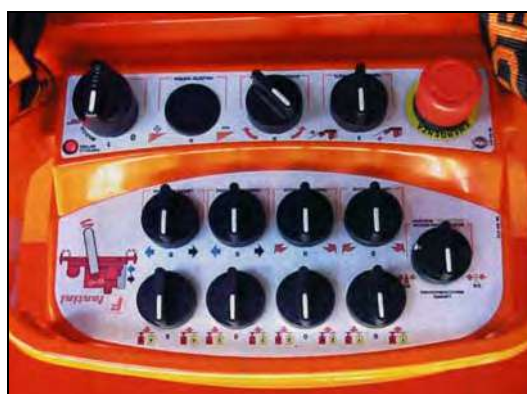
شکل ۳-۲۷-۱۲- تابلوی کنترل ماشین‌هاواژ
