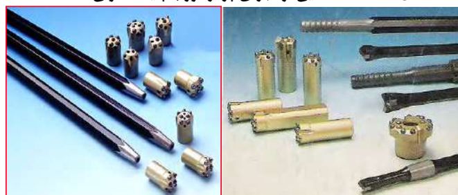
شکل ۳-۷-۲۰- نمایی از اجزای پرفراتور با پایه معمولی
