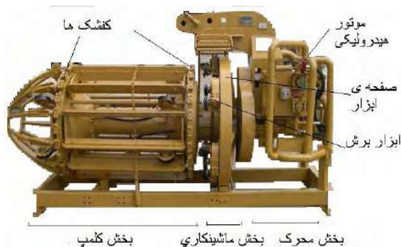
شکل ۵-۶-۳- اجزای اصلی یک ماشین پنج زن
