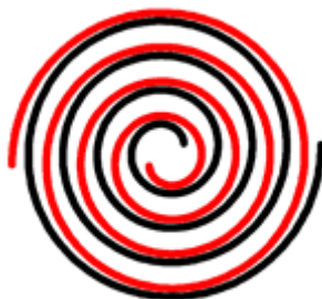
شکل ۶-۱۲-۷- نحوه عمل تراکم در کمپرسور Scroll
