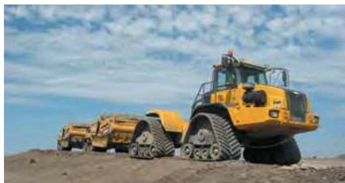
شکل ۲-۶-۱۰- استفاده همزمان از چند اسکرپپر
