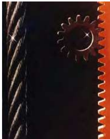
شکل ۴-۱۰-۳- نوع حرکت بالابر در طول دکل به وسیله استفاده از سیستم دندانه و شانه‌ای
