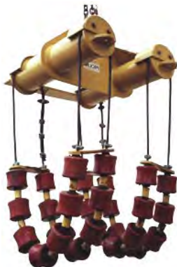
شکل ۵-۴-۳- غلطک‌های لوله گذار
