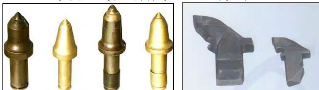
شکل ۳-۲۷-۱۱- نمونه‌هایی از ناخن‌ها و مته‌های ماشین‌هاواژ برای استخراج زغال‌سنگ
