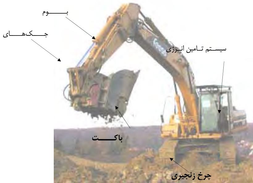
شکل ۳-۵-۷- قسمت‌های اصلی یک دستگاه باکت حفار سنگین
