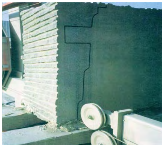
شکل ۳-۱۷-۳- ایجاد شکل‌های مختلف روی سنگ با استفاده از سیم برش
