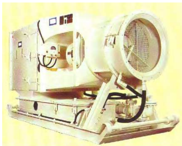
شکل ۶-۱۴-۸- بادبزن گردگیر مرطوب با راندمان بالا جهت استفاده در فعالیتهای زیرزمینی
