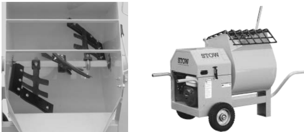
شکل ۴-۱۳-۶- یک دستگاه تولید ملات سیمان، در سمت چپ نمایی از پره‌های موجود در مخزن دیده می‌شود.
