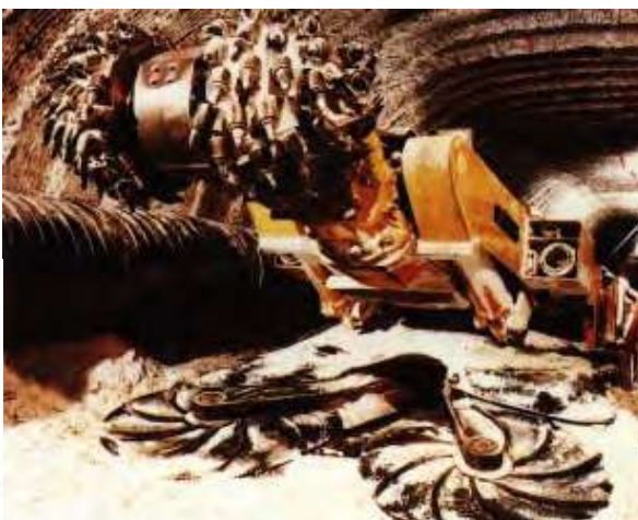
شکل ۳-۱۶-۱۵- ماشین رودهدر با دو صفحه ستاره‌دار دوار
