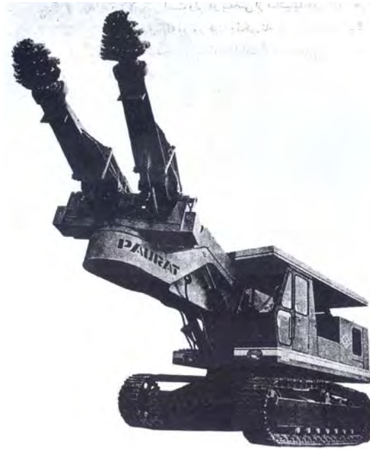
شکل ۳-۱۶-۹- نمایش ماشین رودهدر با دو بازوی حفار
