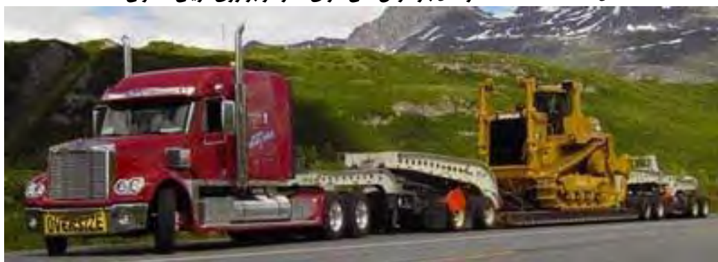
شکل ۶-۳-۱۱- حمل بلدوزر با کفی دارای شترگلو
