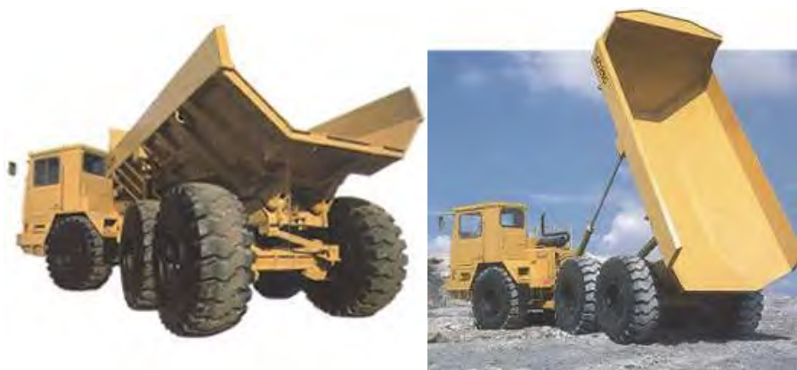
شکل ۲-۷-۵- کامیون کمرشکن در حال تخلیه
