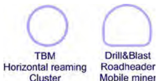
شکل ۳-۲۳-۴- مقاطع قابل حفاری با انواع ماشین‌های حفاری
