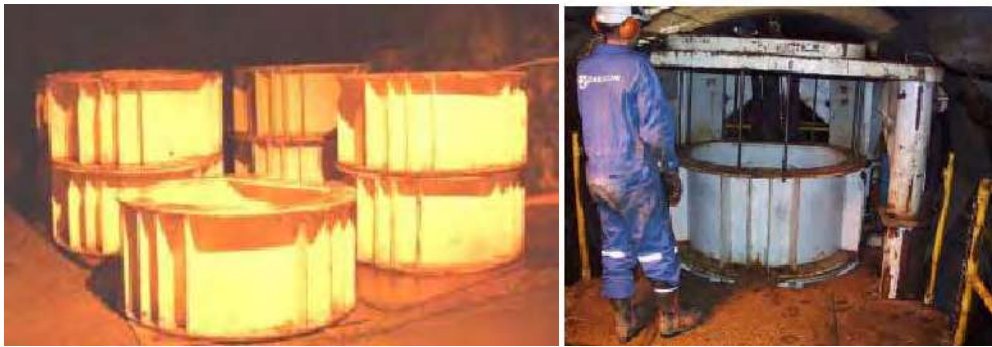
شکل ۳-۲۲-۱۴- نمایی از کیسینگ‌های استاندارد به طول ۸۰ سانتیمتر
