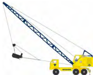
شکل شماره ۴-۱۲-۲- دراگلاین نصب شده روی شناسی کامیون
