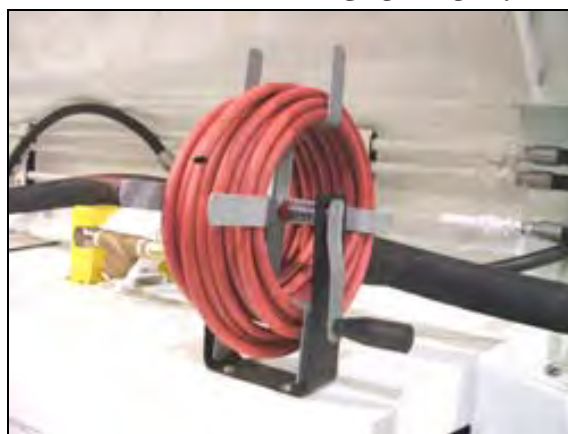
شکل ۳-۲۱-۱۱- لوله (شیلنگ) انعطاف‌پذیر برای خرج‌گذاری
