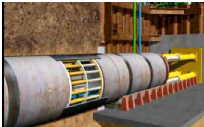
شکل ۵-۱۰-۹- ایستگاه جک های میانی
