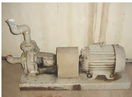
شکل ۶-۱۱-۳- یک پمپ سانتریفوژ متصل به الکتروموتور
