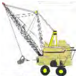
شکل شماره ۳-۱۲-۲- دراگلاین با شناسی چرخ لاستیکی
