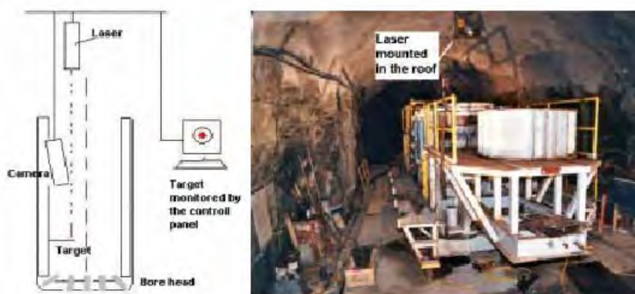
شکل ۳-۲۲-۵- نمایش سیستم لیزری در هدایت ماشین
