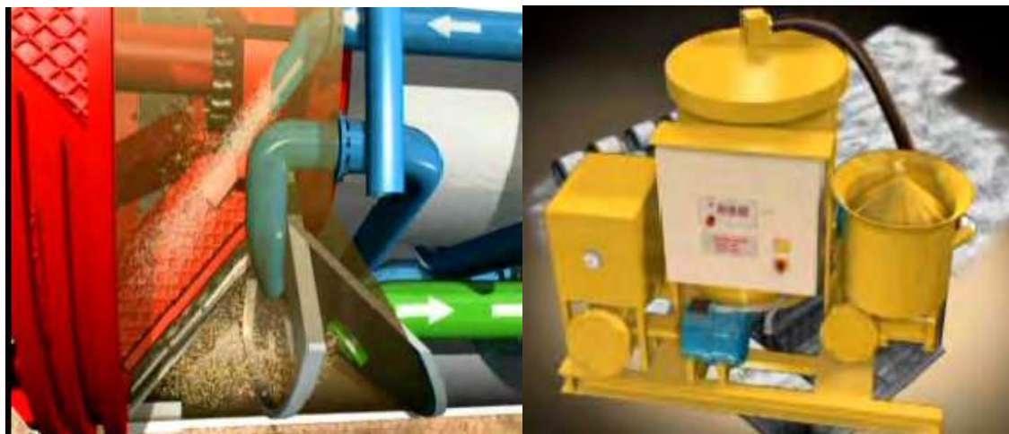
شکل ۵-۱۰-۱۱- الف: دستگاه اختلاط سیال حفاری ب: سیستم انتقال خودکار مصالح مازاد و جایگزینی سیال
