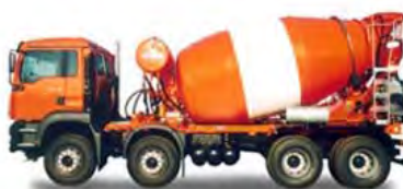
شکل شماره ۴-۹-۴- میکسرهای تخلیه از عقب بر روی شاسی‌های مختلف (تریلی، کامیونی ۴ محور، کارگاهی)
