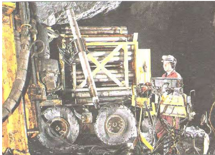
شکل ۳-۱۸-۵- نمایش سیستم جابجایی اتوماتیک لوله‌های حفاری
