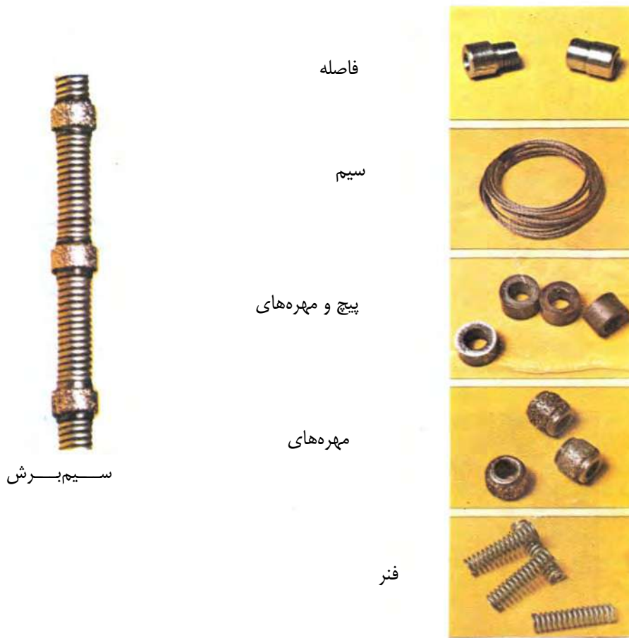
شکل ۳-۱۷-۸- قسمتهای مختلف سیم برش الماسه
