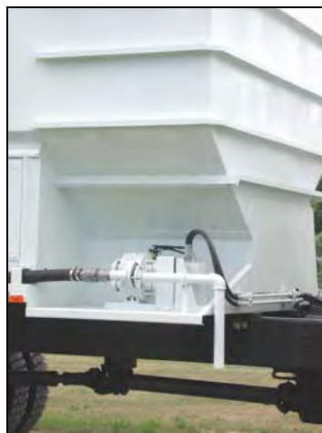
شکل ۳-۲۱-۱۳- پمپ انتقال گازوئیل
