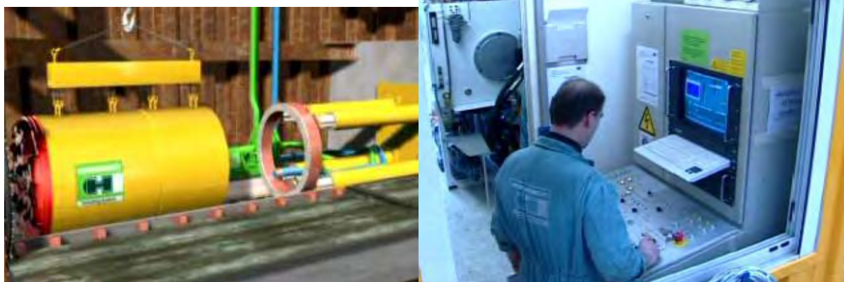
شکل ۹-۶-۱۴- تجهیزات کنترل سیستم
