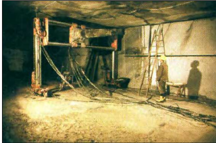
شکل ۳-۲۷-۷- استفاده از ماشین هاواژ در تونل و معدن زیرزمینی
