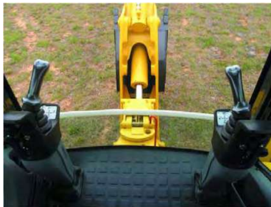
شکل شماره ۲-۹-۹- دستکهای کنترل کننده بیل مکانیکی
