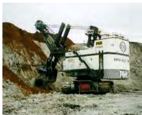
شکل ۳-۱۹-۲- شاول در حال عملیات لایه برداری
