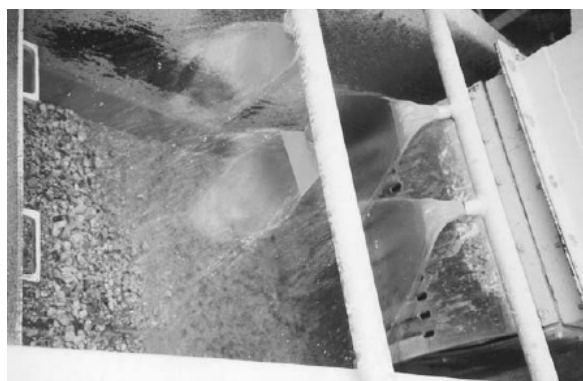
شکل ۴-۱۴-۵- جداسازی سنگدانه‌ها از بقیه مخلوط توسط فشار آب و ویرره
