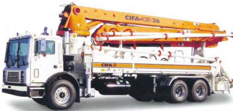
شکل ۴-۱۰-۲- پمپ کامیونی متداول تیرک دار دارای سه بازو مجهز به جک (Outrigger)
