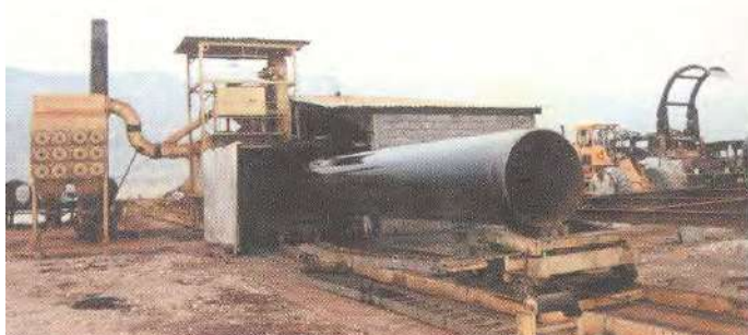
شکل ۵-۴-۵- دستگاه رنگ کاری اتوماتیک (فرایند های سند بلاست و پاشش قیر)
