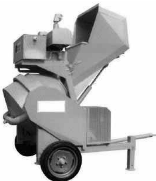
شکل ۴-۱۳-۵- بتونیر با محور متحرک دارای قیف تغذیه
