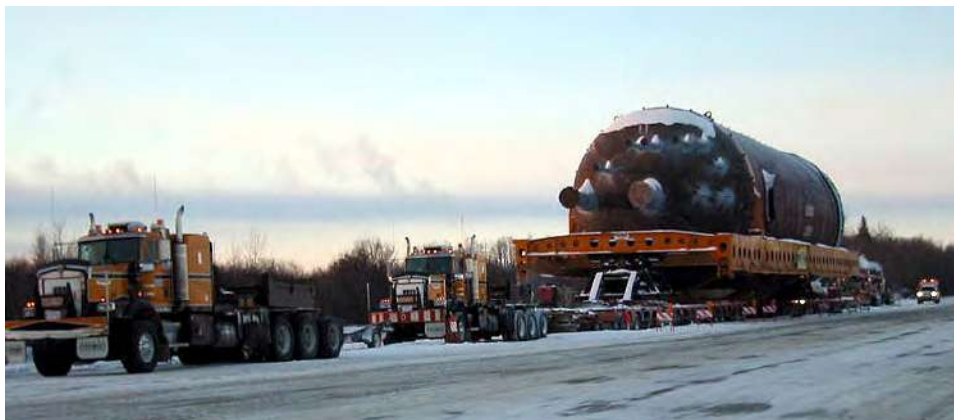
شکل ۳-۲-۶- استفاده از چند کشنده برای حمل بوژی
