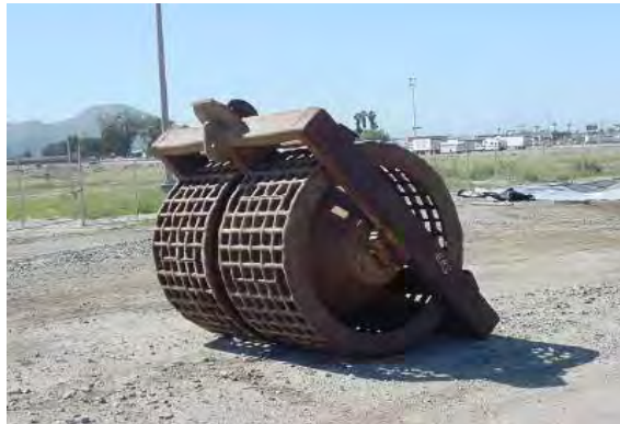
شکل شماره ۲-۴-۲- استوانه شبکه‌ای که با استفاده از تراکتور عمل تراکم خاک را انجام می‌دهد.
