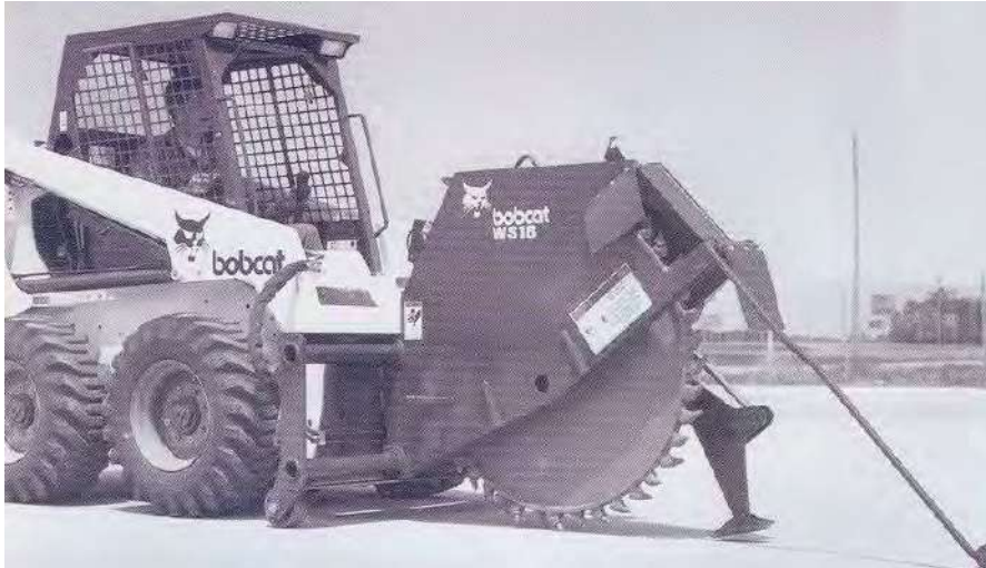
شکل ۲-۱۴-۲- بابکت تجهیز شده برای برش آسفالت
