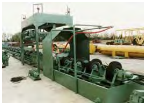
شکل ۵-۴-۹- کارگاه پوشش دهی خارجی با لعاب قیر
