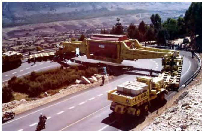
شکل ۶-۲-۹- حمل محموله از مسیر دارای پیچ تند توسط بوژی مخصوص با قابلیت مانور بالا
