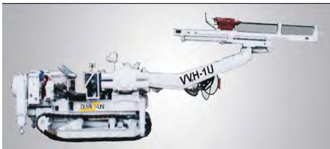
شکل ۳-۱۵-۵- دریل واگن چرخ زنجیری ساخت شرکت DUVAS-UNI
