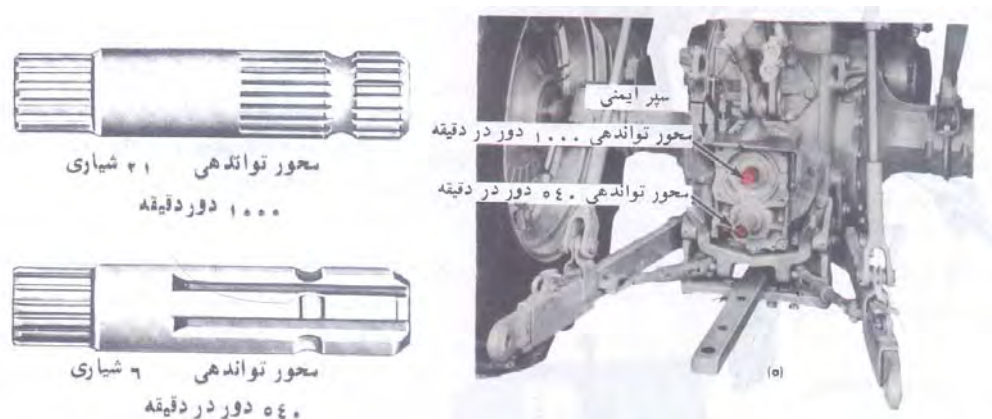
شکل ۶-۱-۷- نحوه اتصال محور تواندهی به تراکتور
