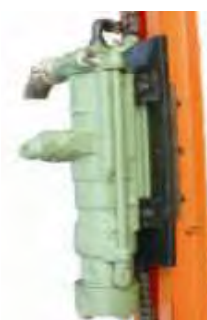
شکل ۳-۱۵-۸- سیستم جلو برنده مته : یک نمونه از سیستم جلوبرنده از نوع چکش سر چال (Top hammer Drifter) با مصرف هوای پایین دیده می‌شود.
