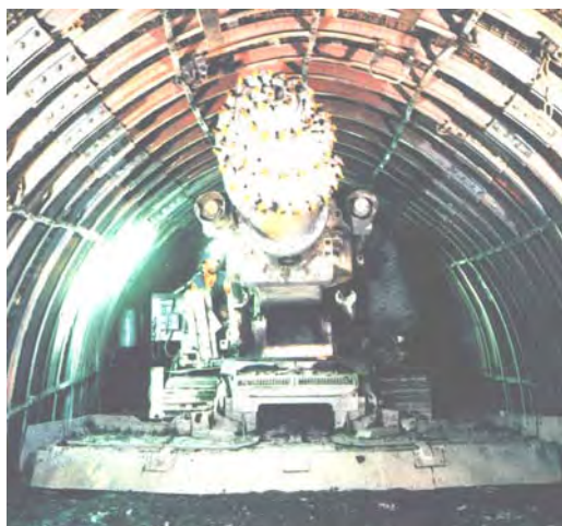
شکل ۳-۱۶-۳- ماشین روده‌در با برش محوری
