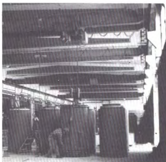
شکل ۴-۱۵-۷- جابه‌جا کردن لوله‌ها همراه با قالب محافظ
