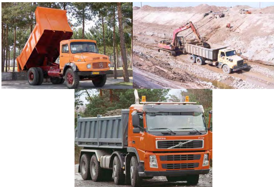
شکل ۲-۷-۲- انواع کامیونهای جاده‌ای (کمپرسی) تولید ایران (۲، ۳ و ۴ محور)
