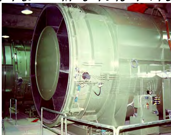
شکل ۶-۱۴-۷- بادبزن محوری یک طبقه با موتور داخلی در معدن زغال در آلمان، بادبزن قابلیت حرکت تمام اتوماتیک از مکانی ثابت به محل عملیات را داراست.
